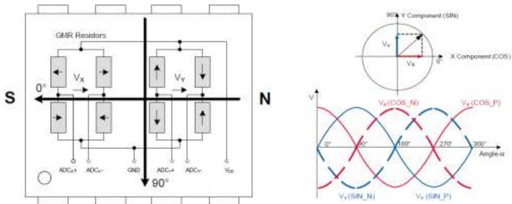
由于 A、B 两相相差 90 度, 可通过比较 A 相在前还是 B 相在前, 以判别编码器的正转与反转, 通过 Z (零位) 脉冲, 可获得编码器的零位参考位。
